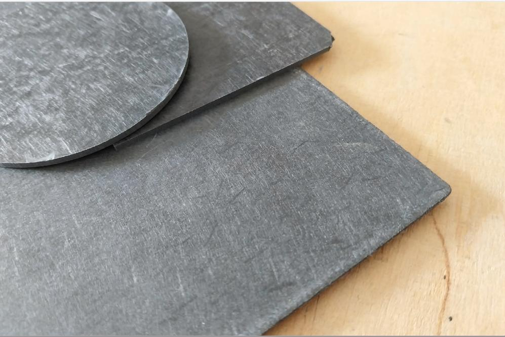
**Bild 1: Untersuchte Carbonfaser/PA6-Halbzeuge**
